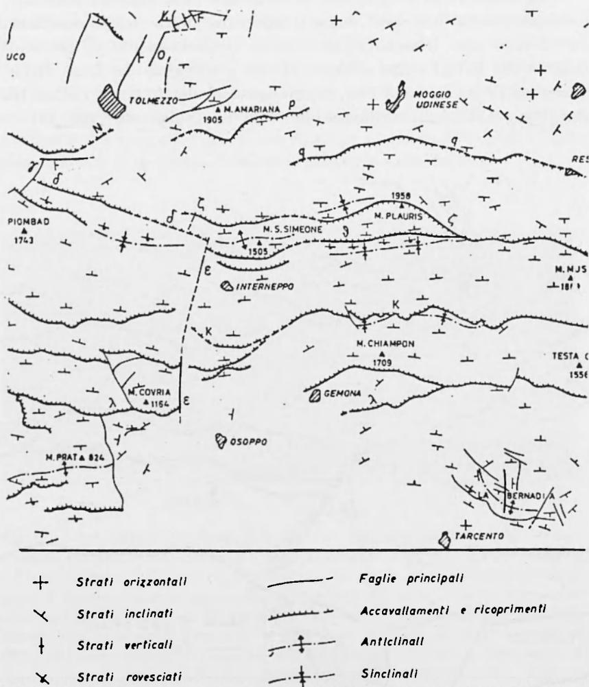
Fig. 19 - Schema tettonico della zona del medio Tagliamento secondo R. Selli (6). Si notino la faglia  $\epsilon$ , che dal Lago di Cavazzo (Fig. 18) si prolunga fino nei pressi di Osoppo; nonché le faglie ad occidente del Monte Covria e ad oriente del Monte Prata.
