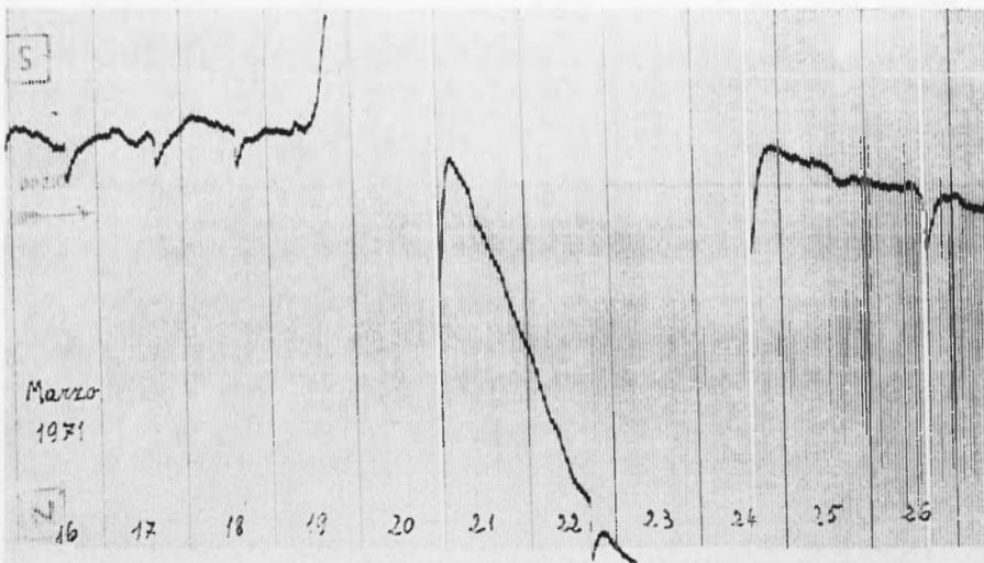
Fig. 12 - Fuoruscita amplissima di entrambe le componenti fino ad appoggiarsi ad un estremo. Impossibilità di ricostruzione del diagramma. Pioggia caduta in quantità inusitata (ca. 250 mm in 3 giorni), come da Fig. 13.
