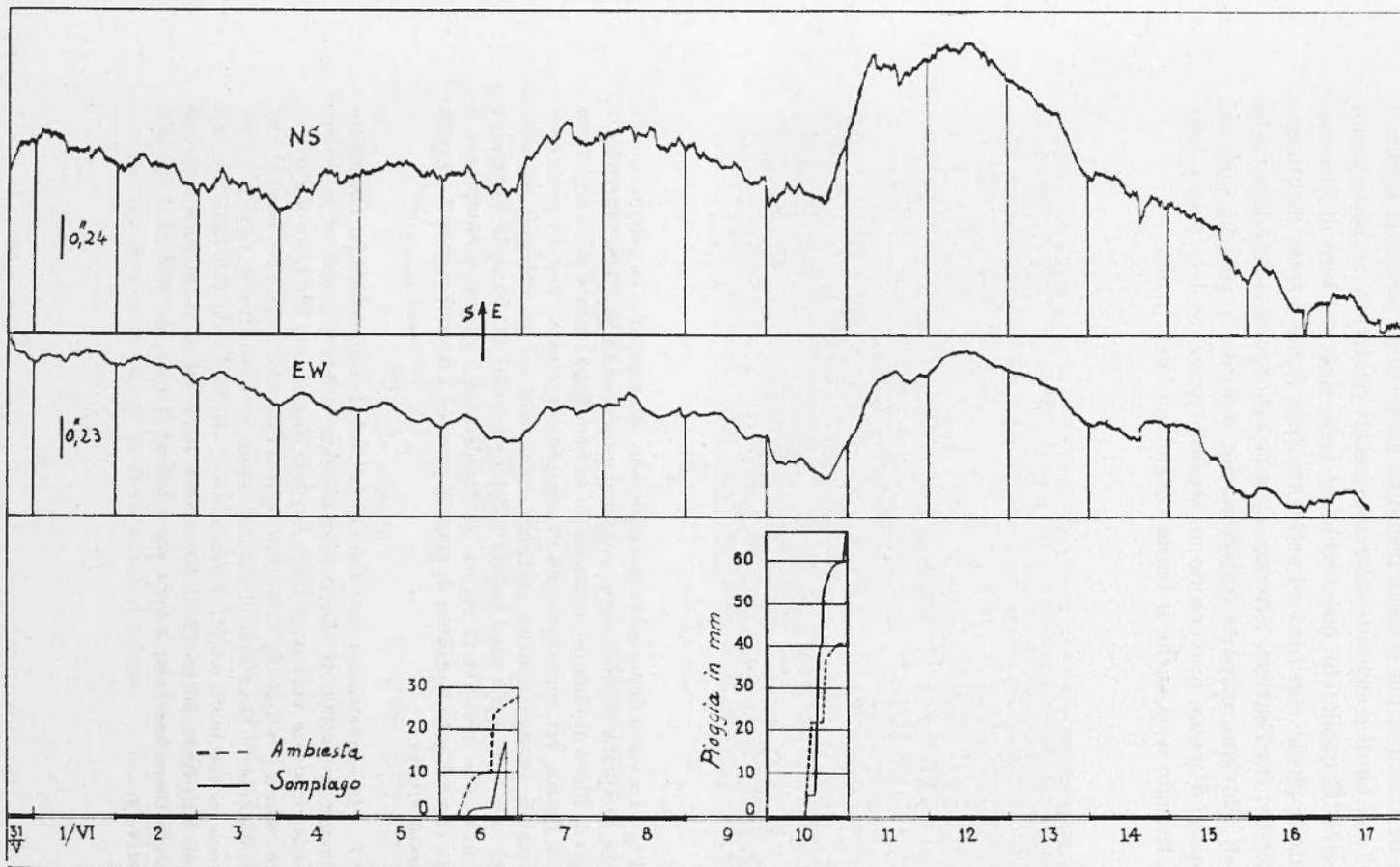
Fig. 16 - Quando la caduta d'acqua non è eccessiva il nuovo clinografo registra compiutamente le variazioni della verticale, senza fuoruscita delle immagini, come nei due casi riportati in figura. (In corrispondenza della lieve caduta di pioggia dal 6 al 7 Giugno 1971, la componente « A » del grande pendolo ha subito uno spostamento verso S33°E di ca. 18 cm, pari a ca. 0'',2 in corrispondenza del 2° caso, si ebbe invece la fuoruscita dell'immagine, nello stesso verso.
