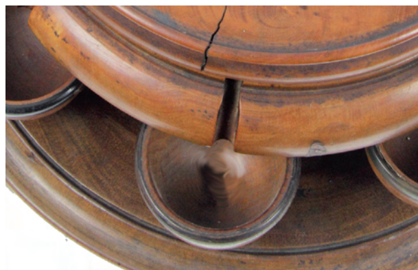
Particolare di uno dei canali di scolo del mercurio dal recipiente superiore e del sottostante bicchierino di raccolta. I bicchierini, opportunamente orientati, corrispondono ai quattro punti cardinali e agli intermedi.
