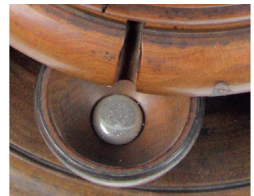
Particolare dello strumento dopo il travaso di mercurio in uno dei bicchierini di legno, conseguente a un moto sismico.
